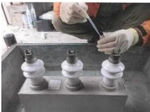
(写真5) 高圧コンデンサ PCB 抽出検査
